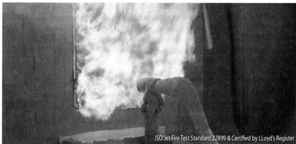
Рис. 1.10. Испытание по международному стандарту ISO 22899–1:2007 «прямого удара» реактивного пламени (Lloyd's Register).
